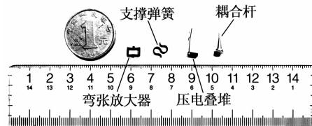
图 9 加工完成的作动器零件
