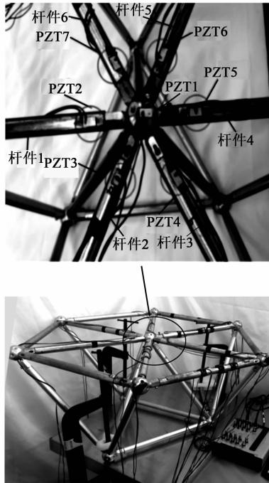
图 4 螺栓球节点网架模型和杆件、压电陶瓷片的编号
