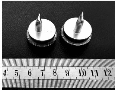
图6 封装后的微半球样机
