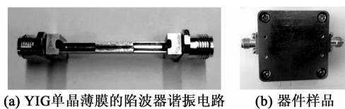
图6 YIG 单晶薄膜谐振电路与器件样品
